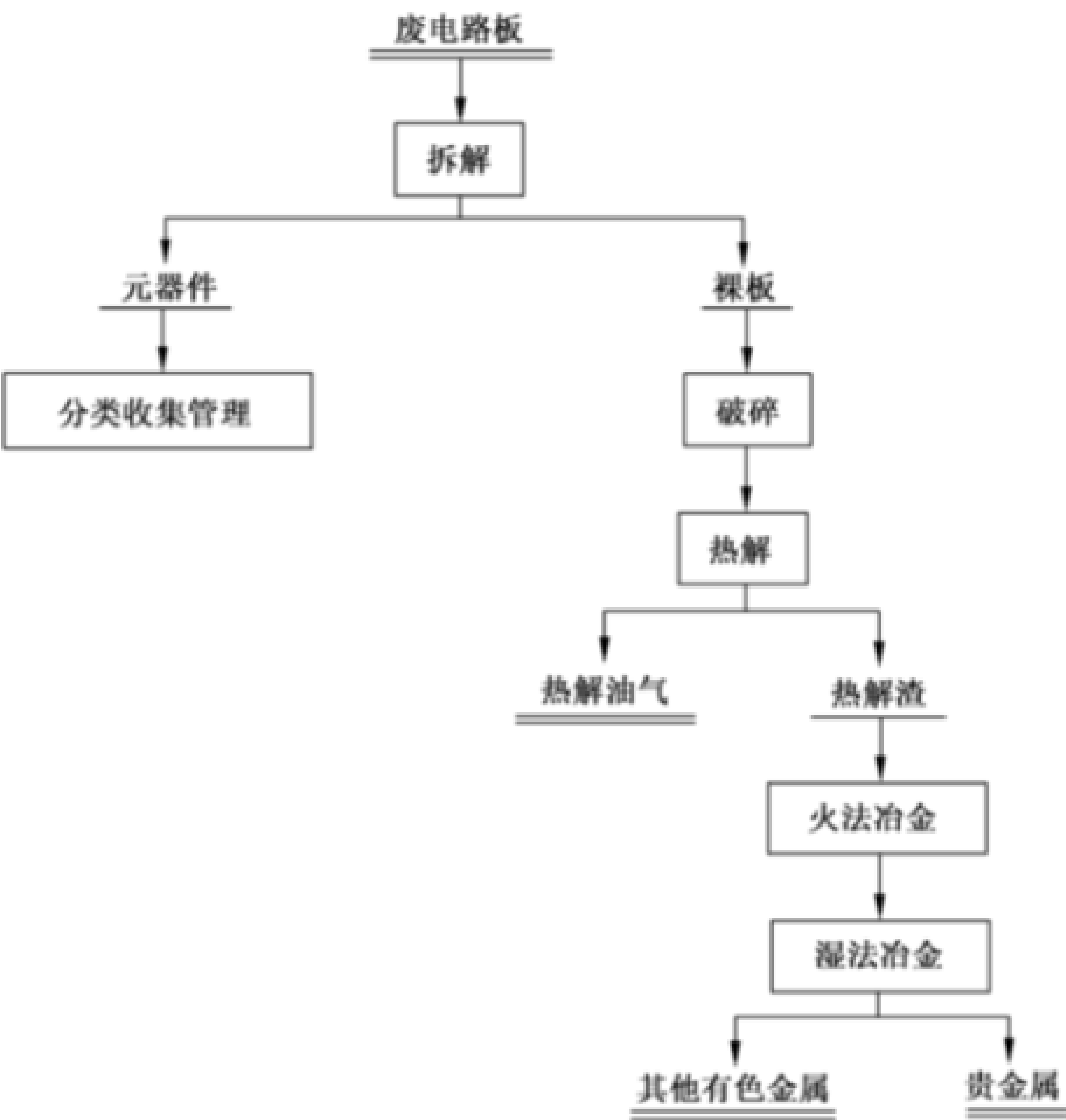
图 A.1 废电路板处理处置工艺
