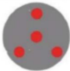
图 1 电极片厚度测量位置示意图
