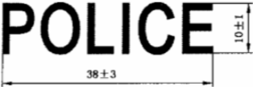
图 5 袖头刺绣图案式样及规格
