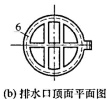
图 4.4.5-2 圆形排水口安装示意
