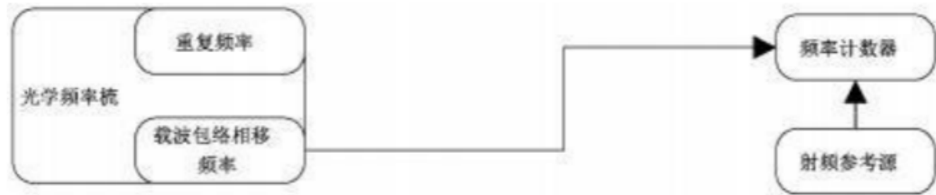
图 4 载波包络相移频率不稳定性测试框图
