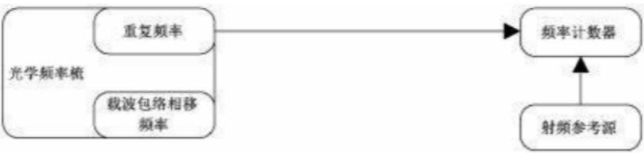
图 3 重复频率不稳定的测试框图
