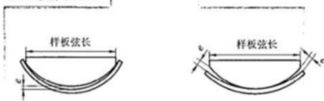
图 3 球瓣片曲率偏差检查示意
