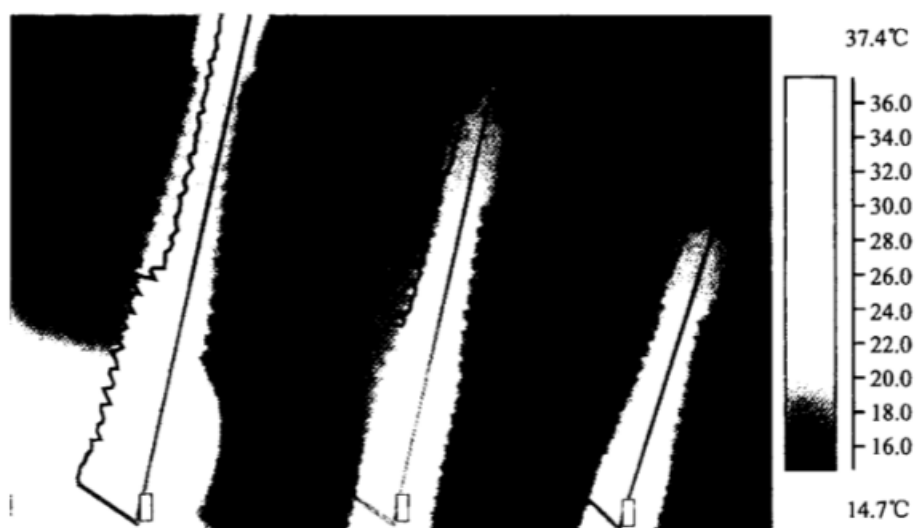
图 J. 30 变压器的套管温度异常，套管缺油
