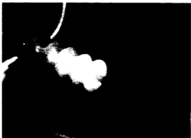
图 J.39 瓷绝缘子发热，表面污秽
