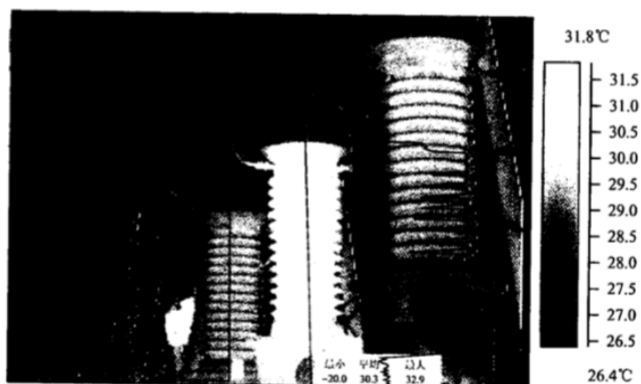
图 J.6 互感器介质损耗偏高发热，B 相
