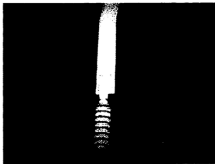
图 J. 29 35kV 电缆接头发热，接触不良
