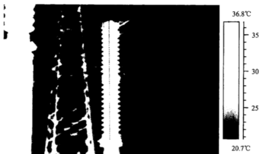
图 J. 12 耦合电容器下节介质损耗偏大发热
