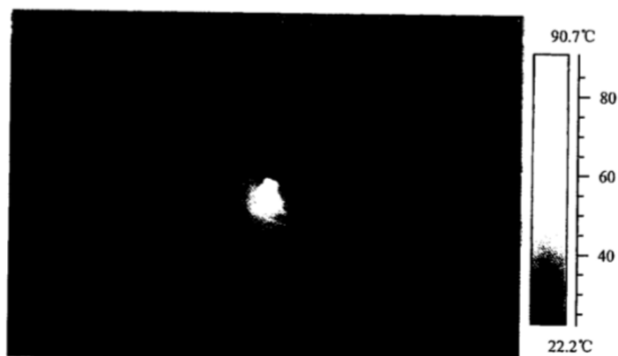
图 J.7 互感器变比接头发热
