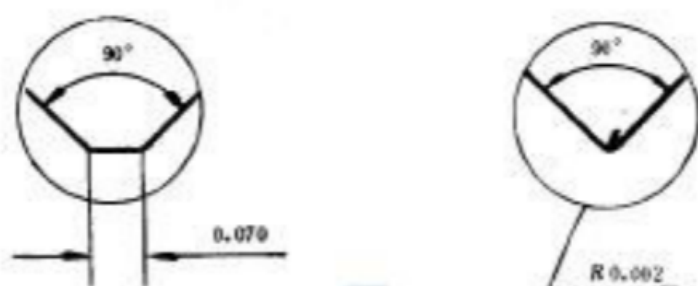
图 1 测头触针形状和尺寸
