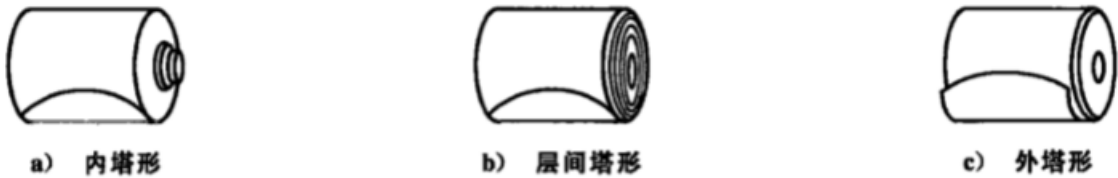
图 1 常见钢带的塔形形貌
