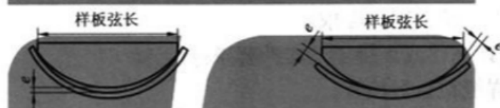
图3 球瓣片曲率偏差检查示意
