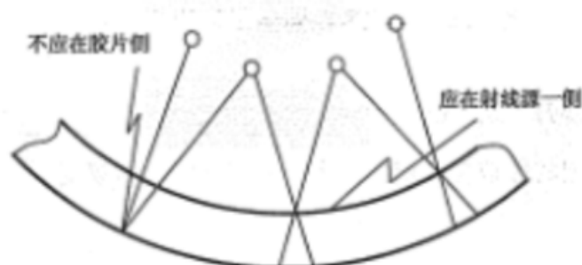
图 J.2 射线源到胶片距离 F 小于曲面工件的曲率半径
