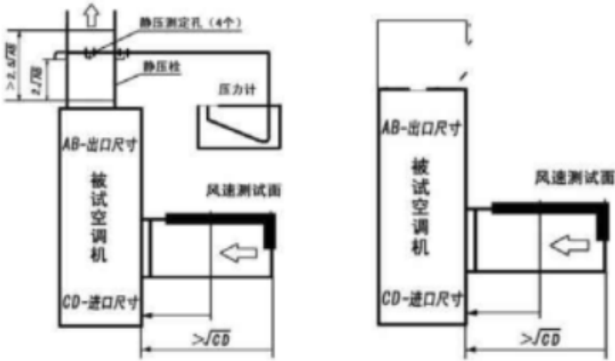
图3 风管送风型式检测装置
