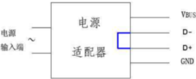
图3 电源适配器中 D+到 D-短接示意图
