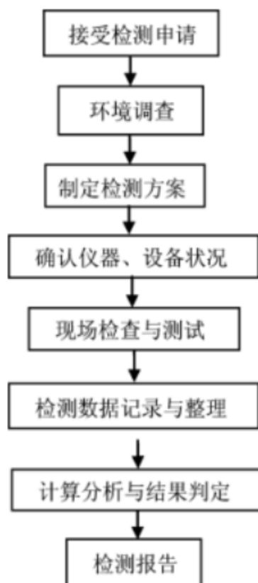
图 1 防雷装置和防静电接地装置检测工作程序框图
