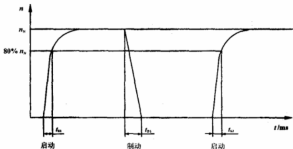
图3 启动、制动时间波形图
