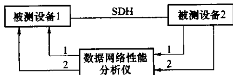
图 5.5.2-3 用户安全隔离测试连接
