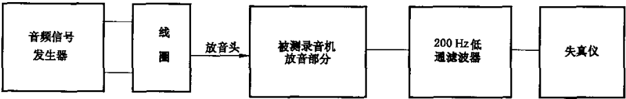
图 4 放音通道谐波失真测试方框图
