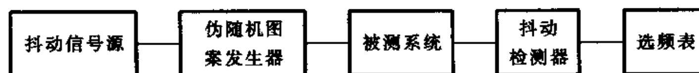
图 13 抖动转移特性的测量配置
