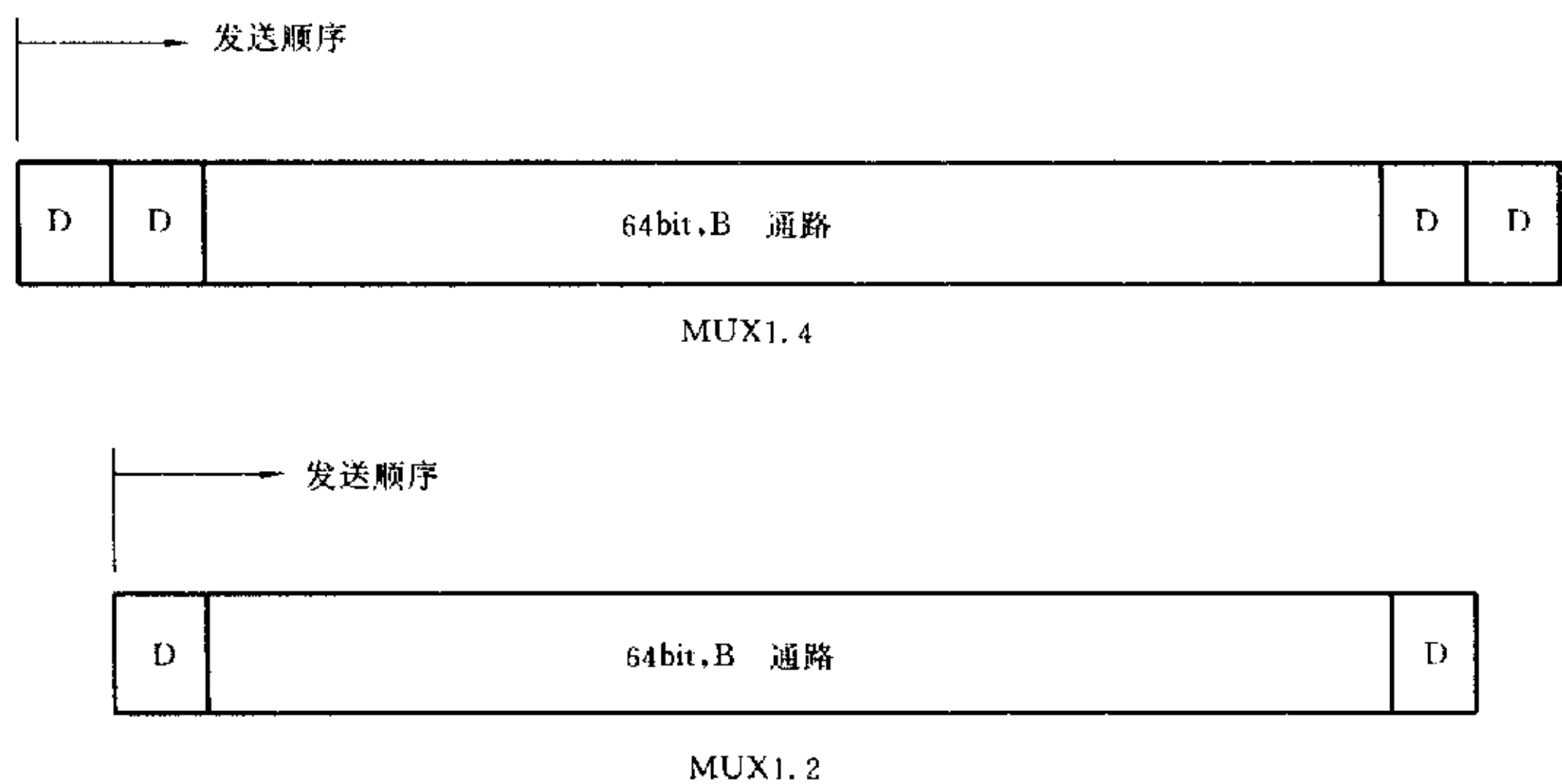
图 3 MUX1(复用结构)
