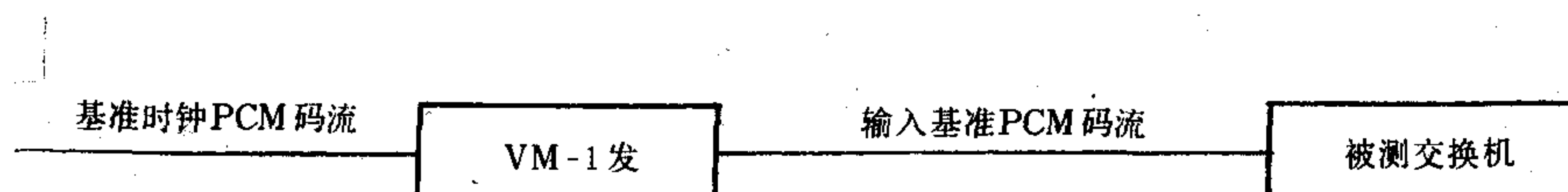
图 131 失基准或失帧告警检测原理图
