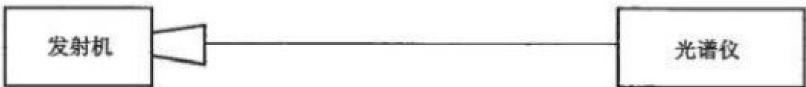
图 1 发射波长测试连接设备示意图
