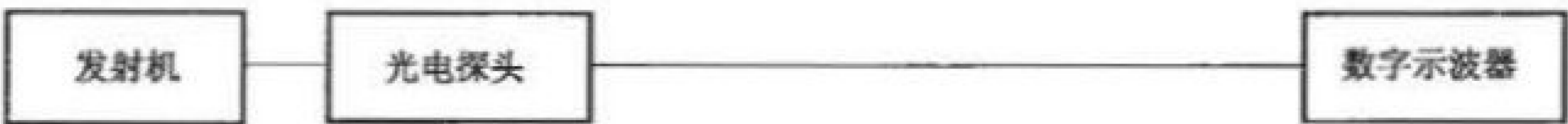
图 3 发射机调制频率测试连接设备示意图
