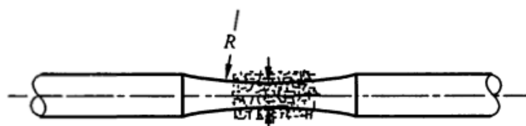
图 6 两端之间有连续半径,适用于旋转梁或轴向加载的试样
