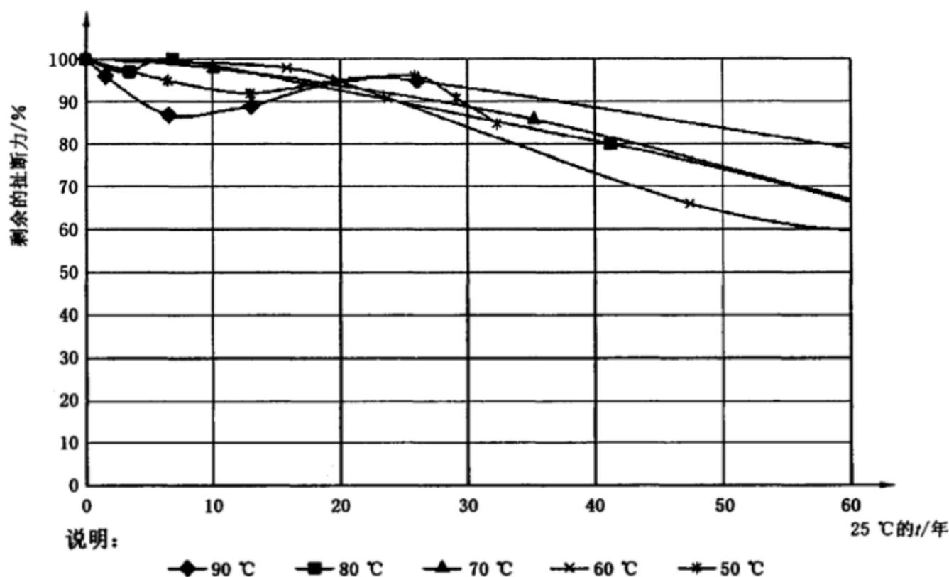
注:如果在产品不能达到规定要求前允许扯断力降低 20%,那么货架寿命将超过 30 年。允许的最大货架寿命 3 年也因此可以被证实。
