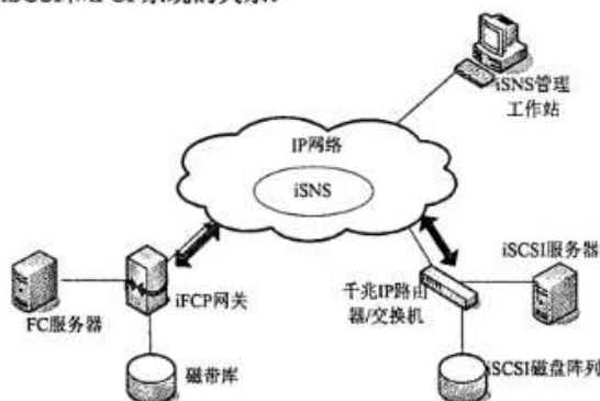
图2 iSNS 与 iSCSI 和 iFCP 系统的关系
