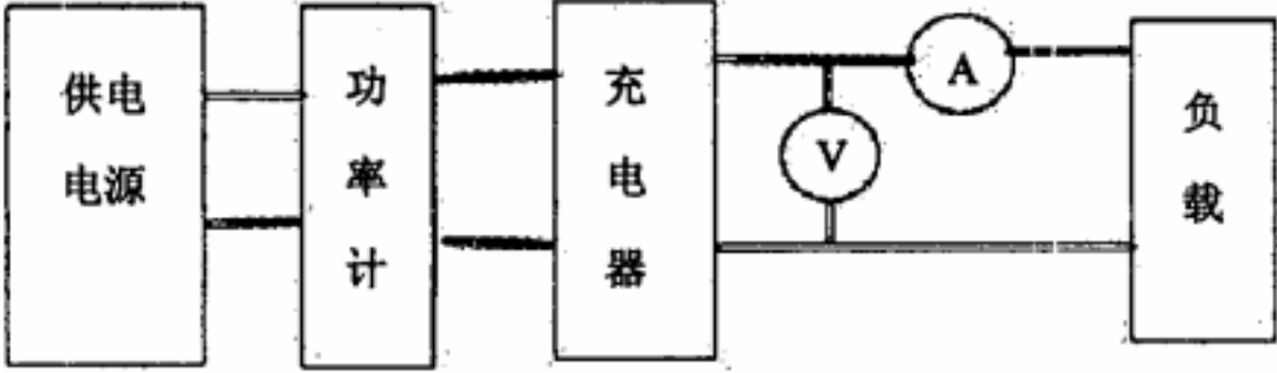
图4 电源适配器平均效率测试连接图
