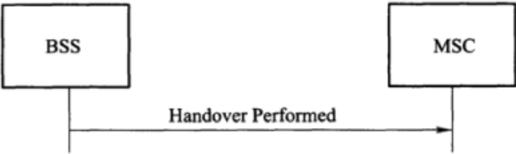
图 52 “业务用户抢占组呼上行链路进行小区间内部切换”信令流程
