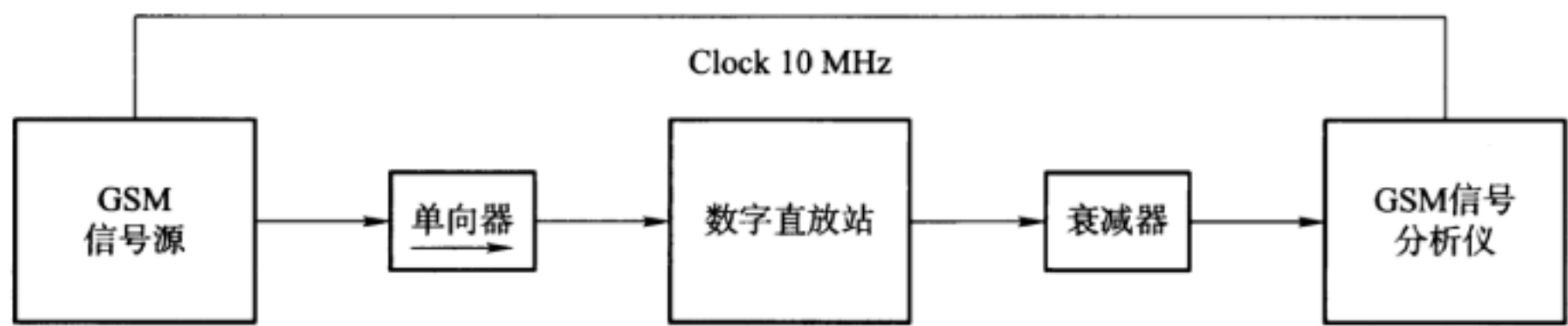
图 2 标称线性输出功率测试连接图
