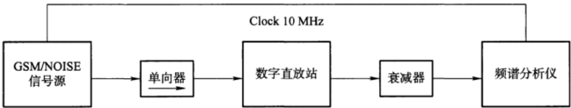
图 12 上行噪声抑制测试连接图
