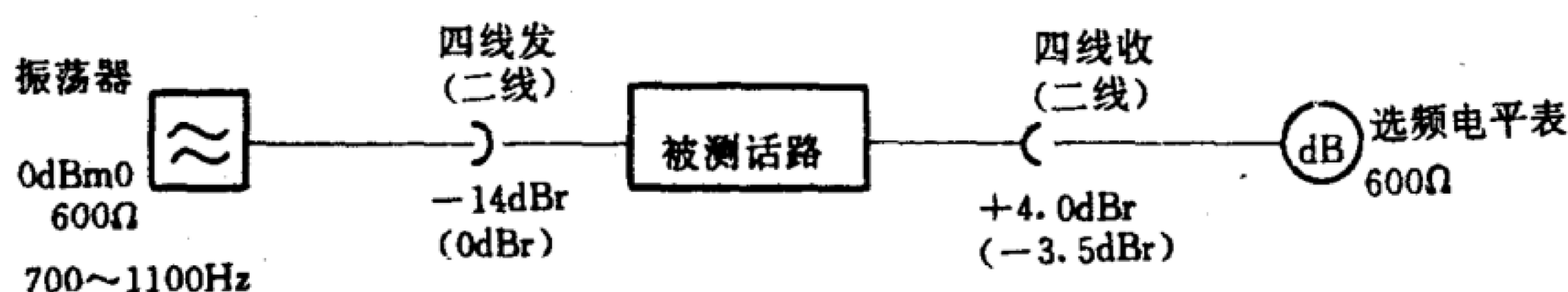
图 13 信道输出口的寄生带内信号(包括谐波失真)测试
