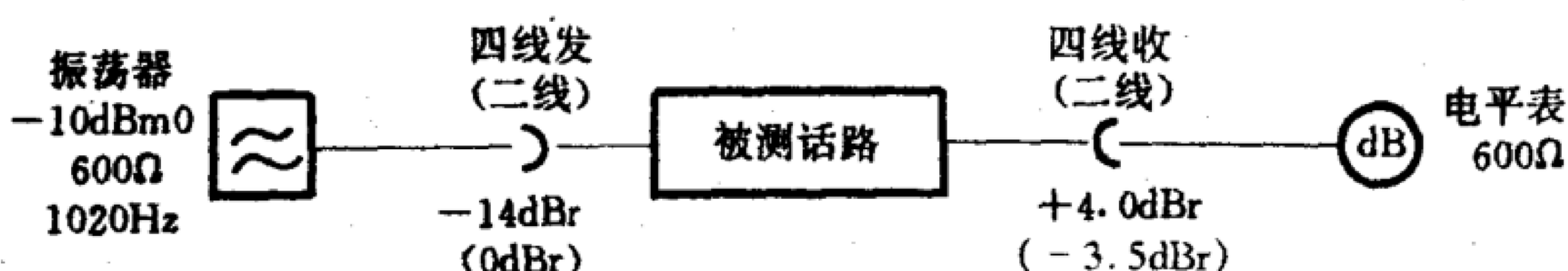
图 24 电平持恒度测试
