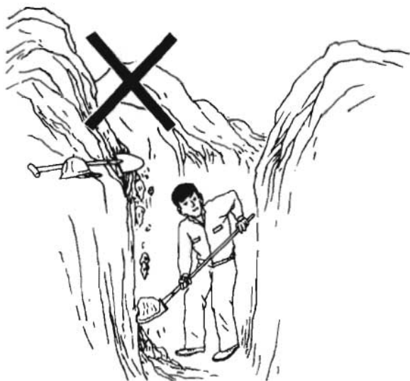
图 5.2.1 弃土应距坑边 0.4 m 以外，堆土高度不应超过 1.5 m
