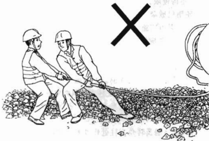
图 3.2.4—2 光电缆不得在硬质地面上拖拉
