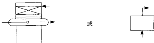
不带过热器水管锅炉
