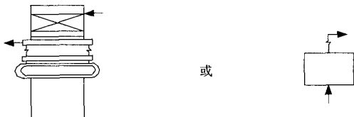
带过热器水管锅炉
