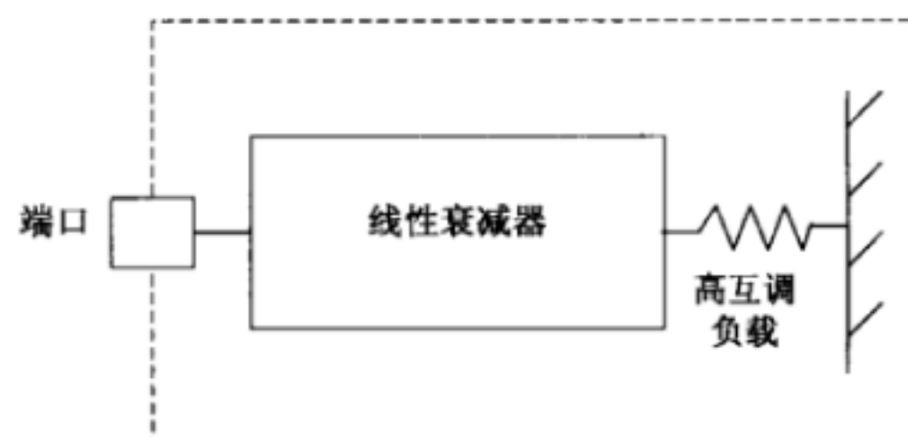
图 C.2 附加线性衰减器的集成低互调负载
