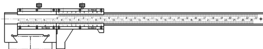
a) I 型通用燕尾测量尺零值误差测量
