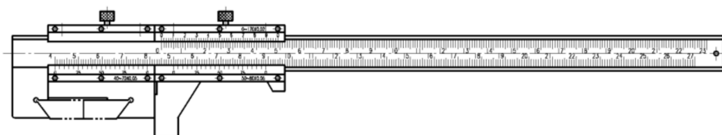
b) 通用燕尾测量尺和Ⅱ型非通用燕尾测量尺零值误差测量
