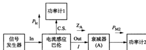
图 J.11 电流感应巴伦校准设备连接
