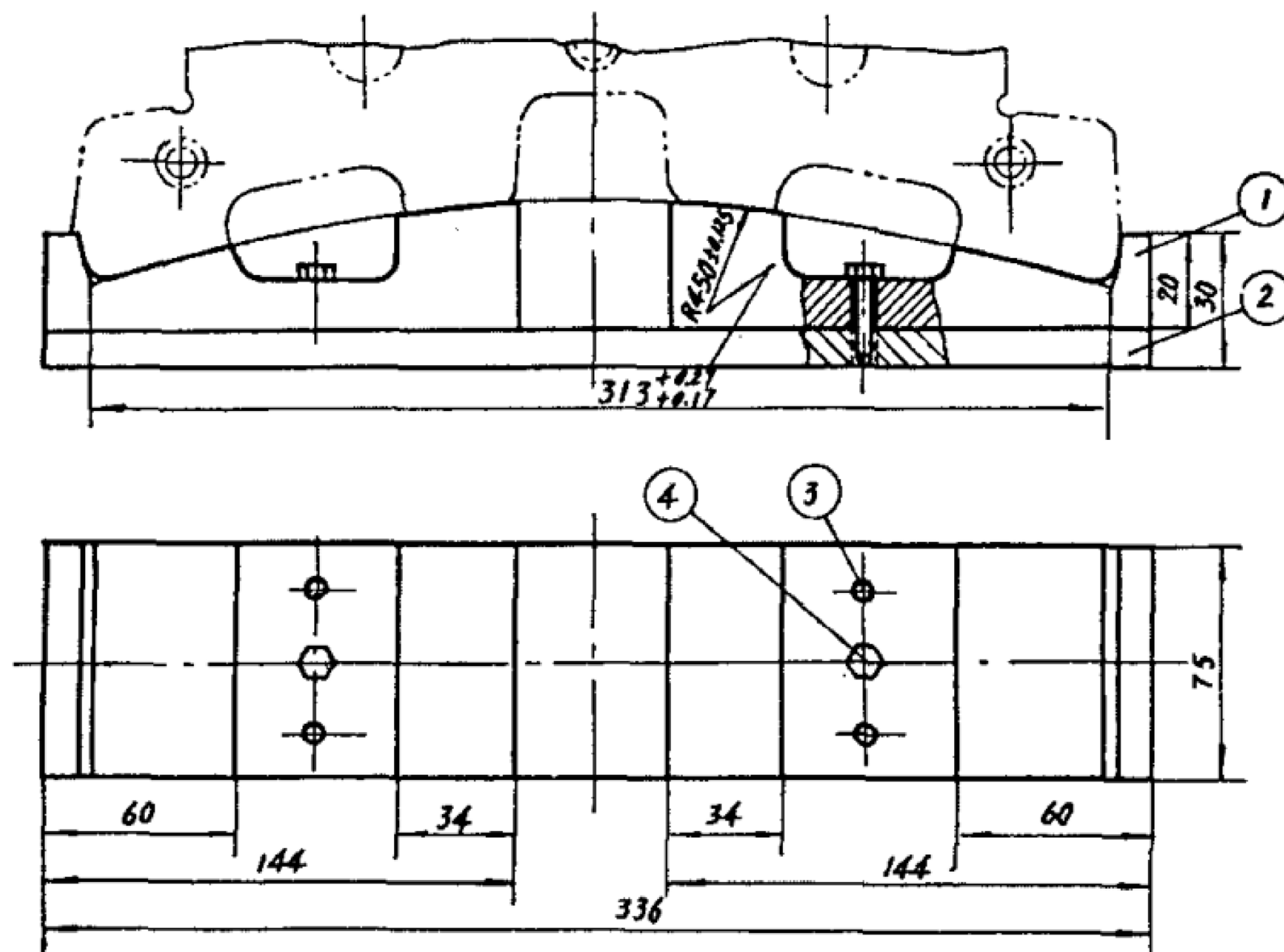
标记示例: 闸瓦瓦背校对样板。
