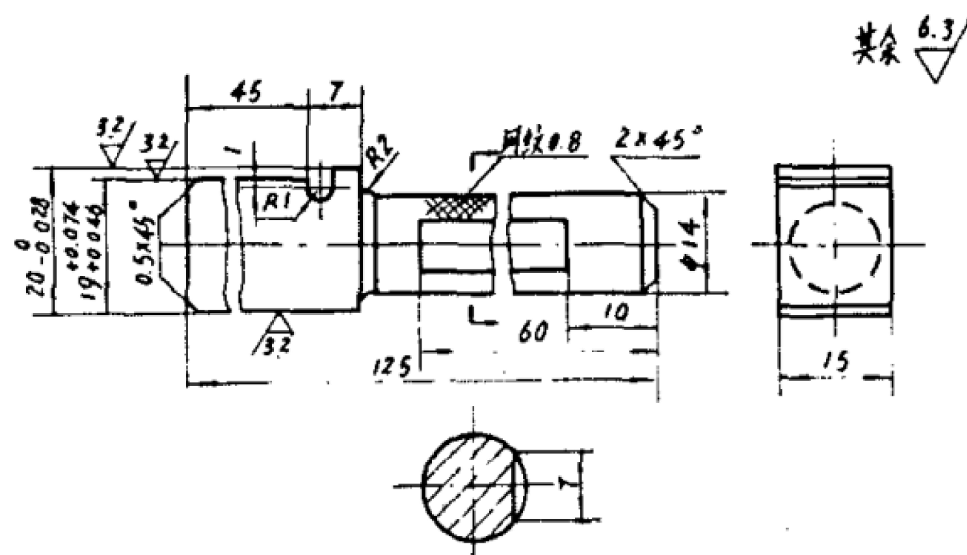
标记示例：闸瓦(高磷)鼻孔塞规
