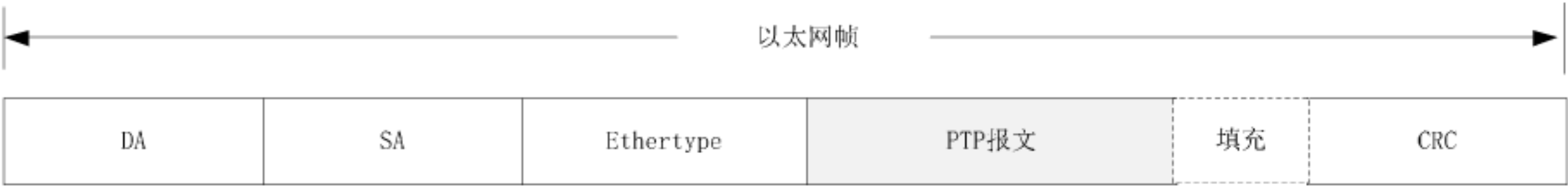
图7 不带 VLAN 的 PTP 以太网封装方式
