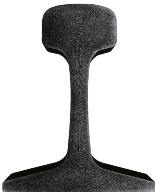
图 C.7 从轨腰延伸到轨头和轨底的分散分布的中心轨腰条纹
