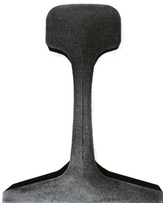
图 C.6 长度超过 64 mm 的条纹
