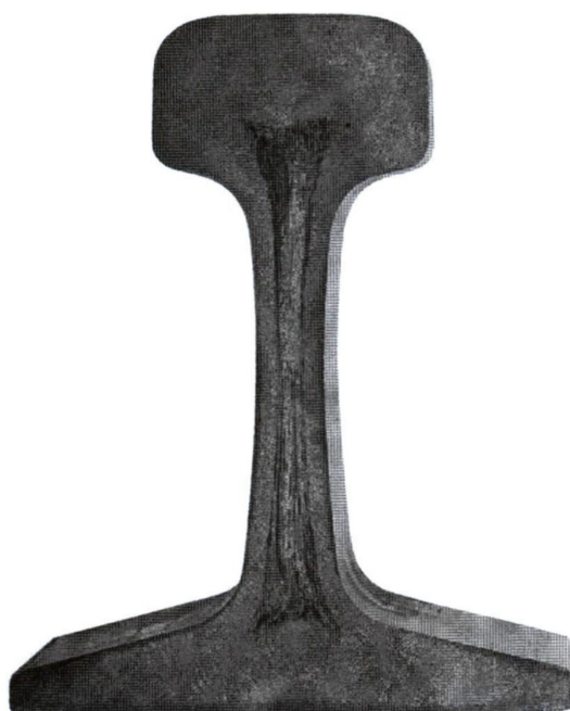
图 C.10 宽度大于 6 mm 并延伸到轨头或轨底内 13 mm 以上的正偏析或负偏析
