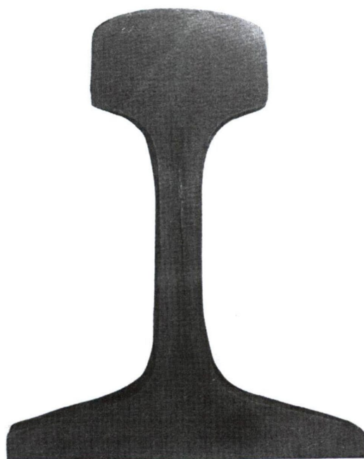
图 C.3 任何尺寸的缩孔
