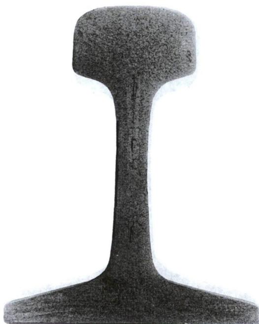
图 C.4 延伸至轨头的中心轨腰条纹
