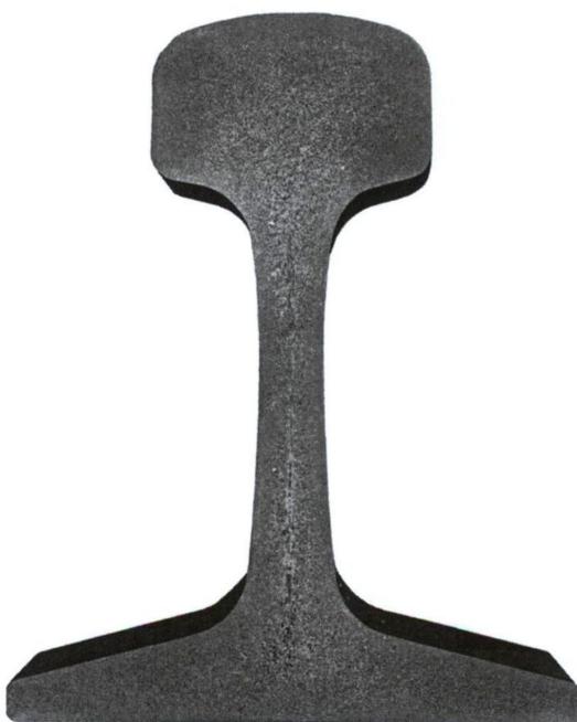
图 C.5 延伸至轨底的中心轨腰条纹
