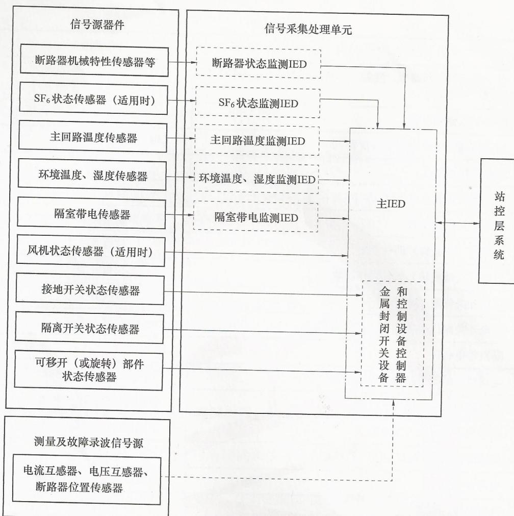
注 1：开关元件和可移开（或旋转）部件的状态传感器按具体的金属封闭开关设备和控制设备类型配置。
