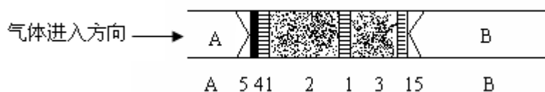
图1 玻璃采样管结构示意图
