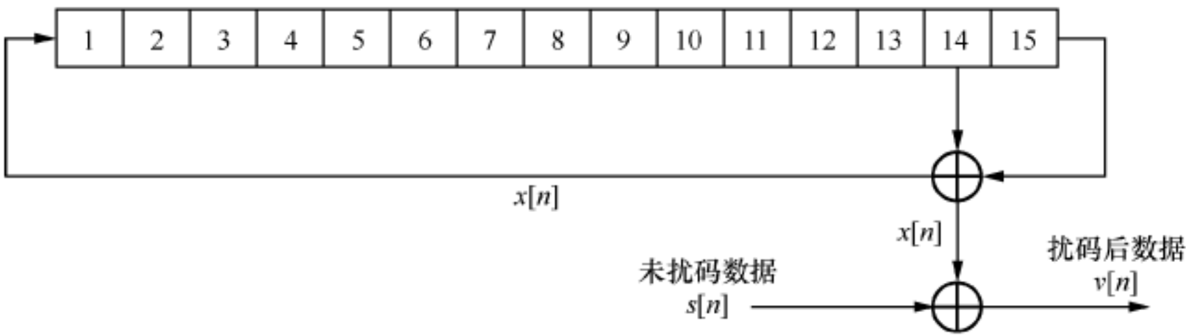
图 13 基于反馈线性移位寄存器的扰码器结构示意图
