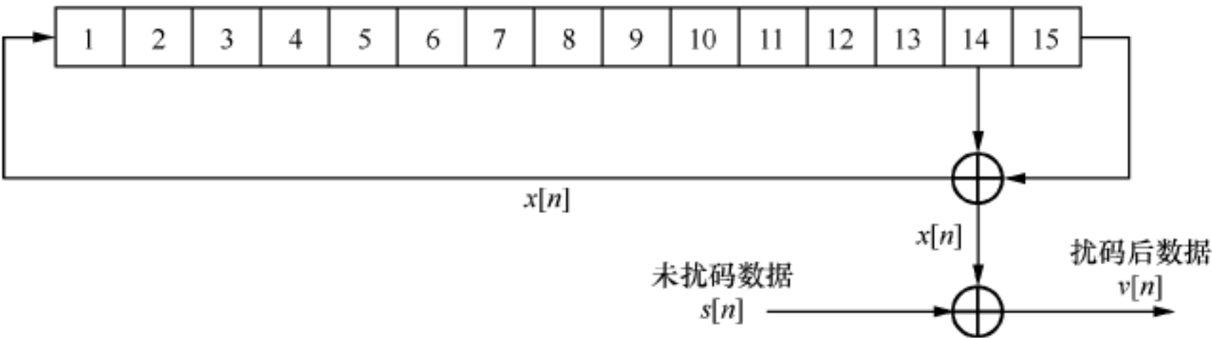
图10 基于反馈线性移位寄存器的扰码器结构示意图
