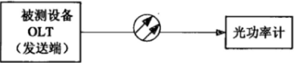
图1 OLT 平均发送光功率测试配置
