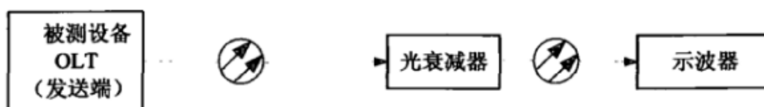
图3 OLT 发射机眼图/消光比测试配置
