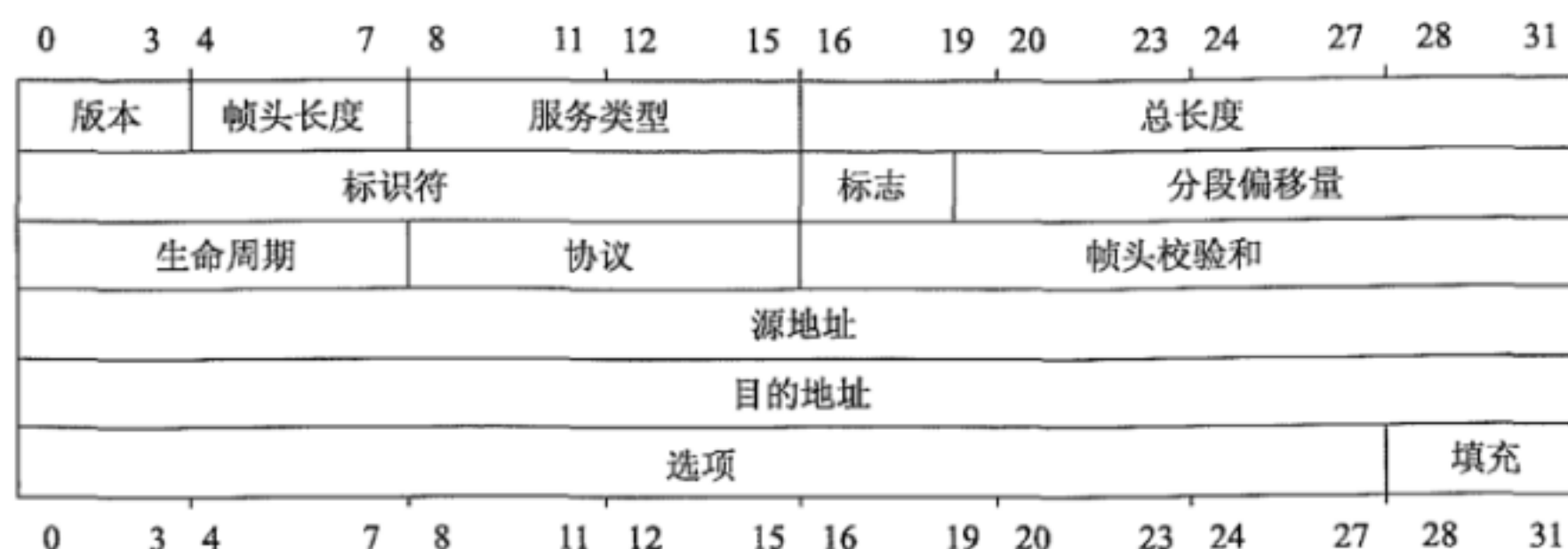
图46 IP 协议的帧头结构
