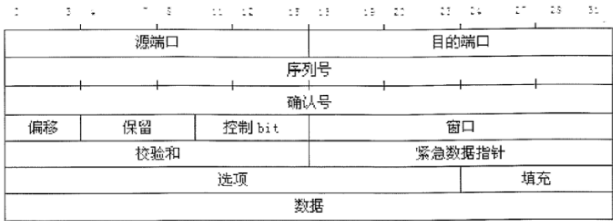
图52 TCP 协议的帧结构
