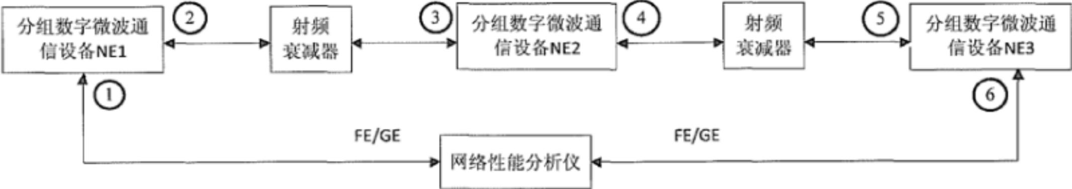
图 36 连续性检测功能测试配置
