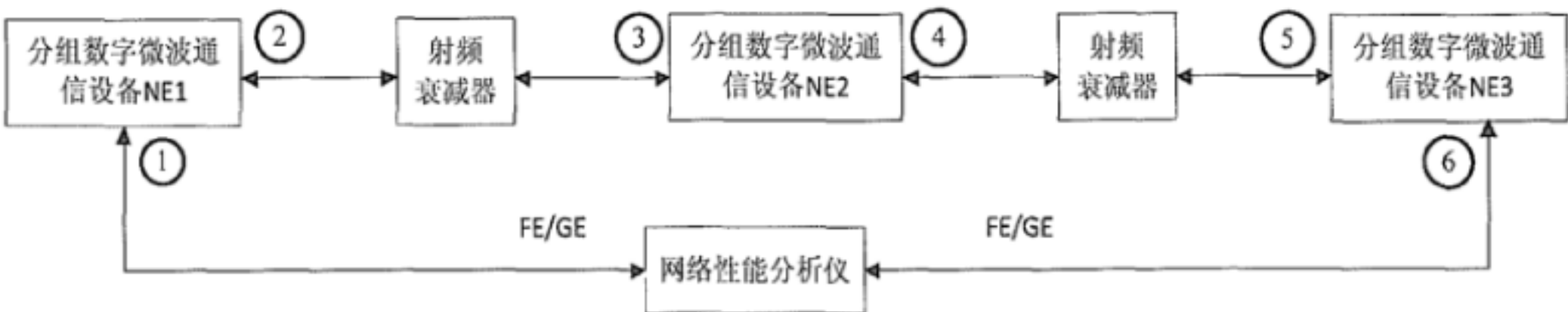
图 39 性能测试组网
