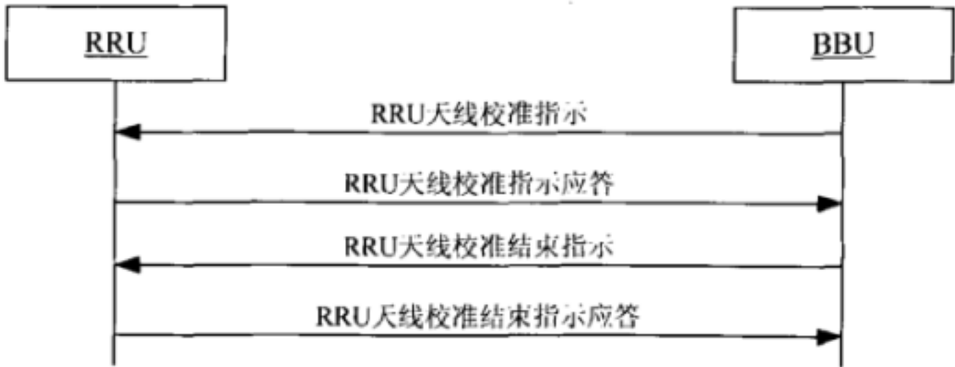
图24 BBU 侧天线校准流程触发流程
