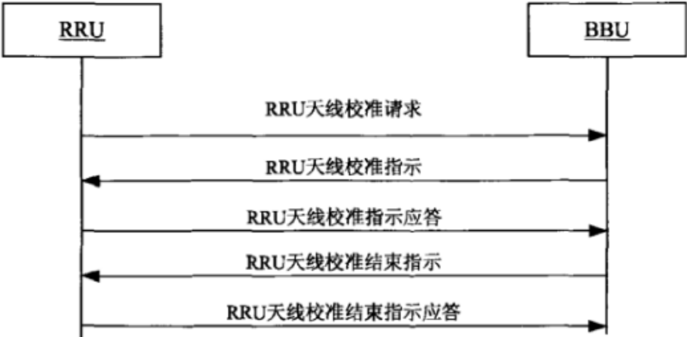
图23 RRU 侧天线校准流程触发流程
