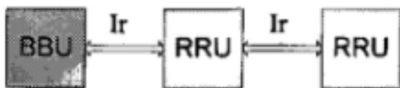
图5 BBU 单元和 RRU 单元的链型连接
