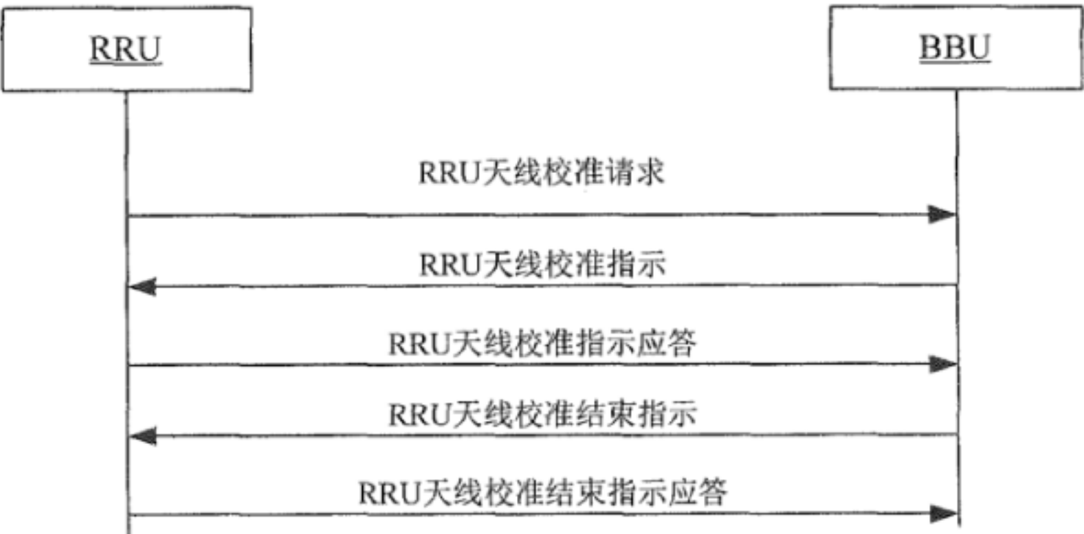
图23 RRU 侧天线校准流程触发流程
