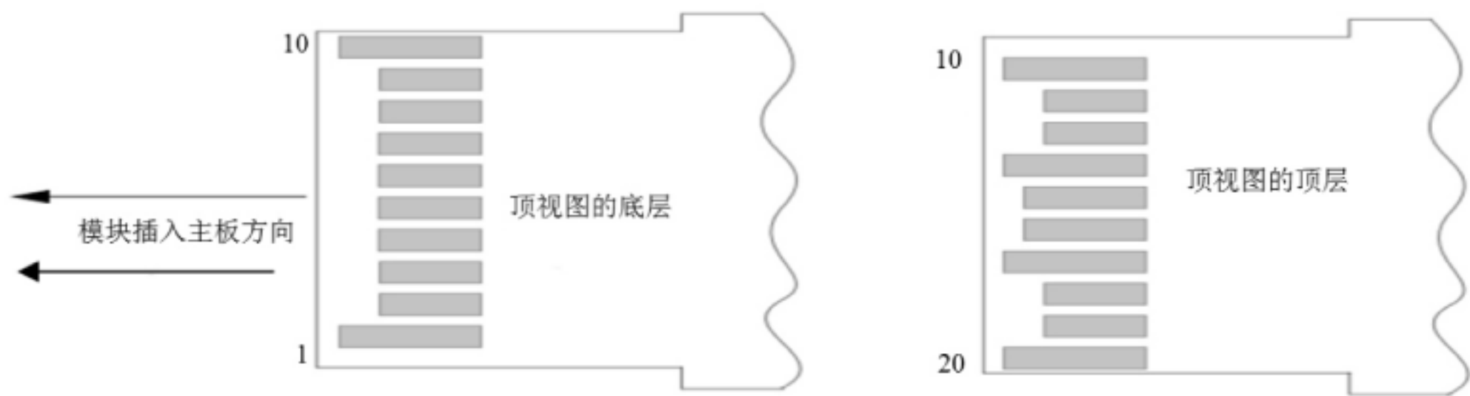
图C.7 引出管脚（金手指）顶视
