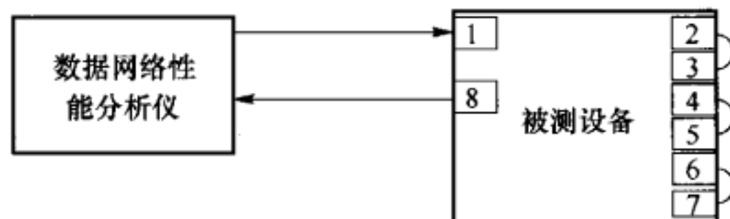
图 4.4.1-2 交换容量测试示意图
