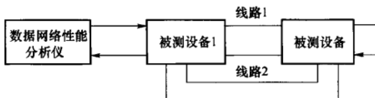
图 4.3.1-5 LCAS 功能测试示意图
