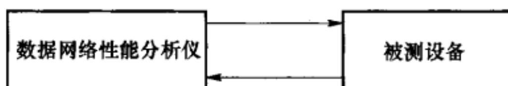
图 4.3.1-2 流量控制/统计计数功能测试示意图
