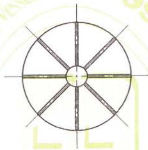
图 9 仓壳顶加强筋结构
