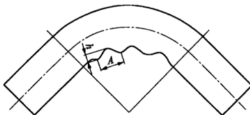
图 1 弯管波浪度示意图
