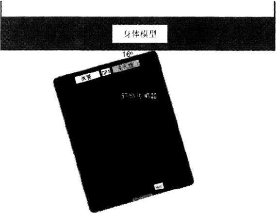
图 2 平板终端顶端垂直倾斜时右侧角距离感应器触发功率回退的角度的验证示例
